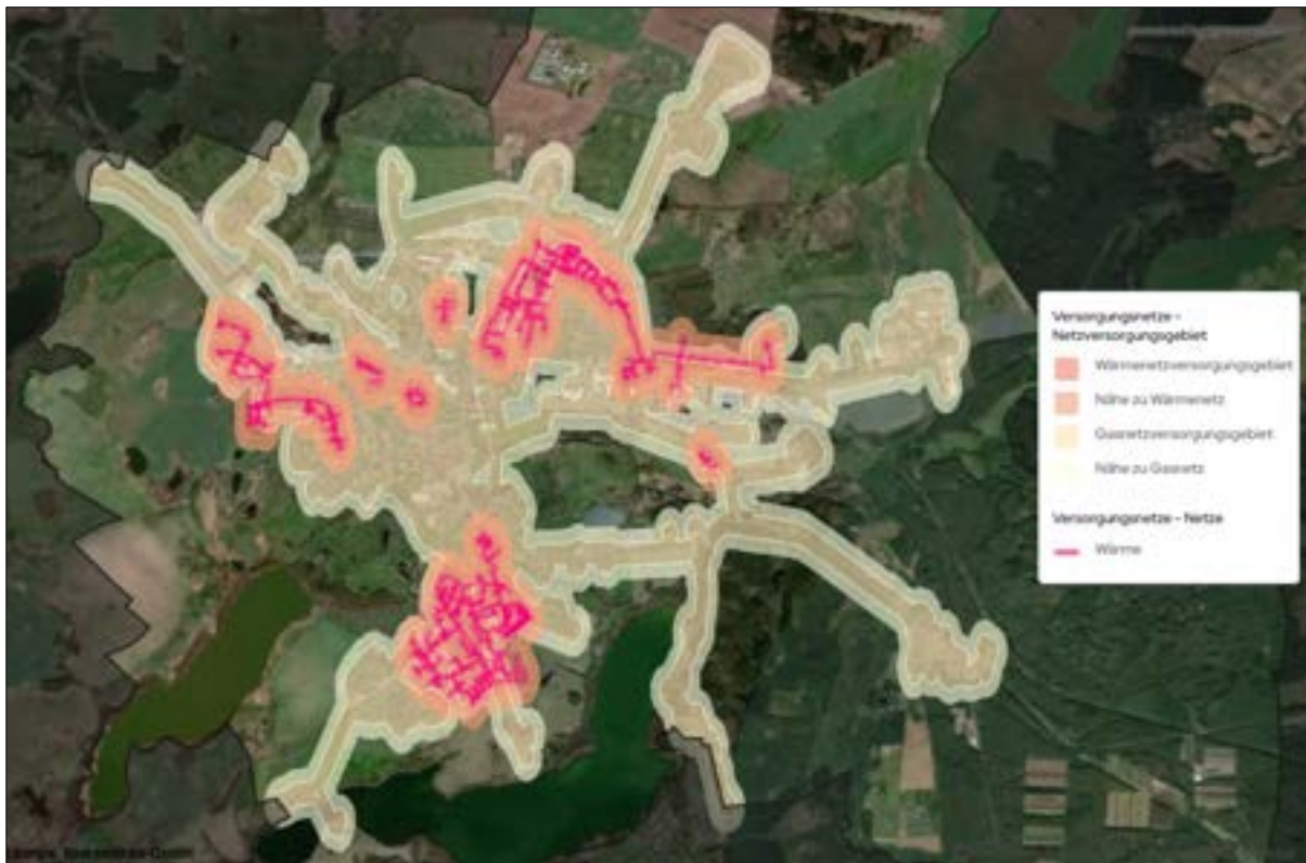
Abbildung 178: Eignungsgebiete für Wärmenetze oder Einzelversorgung - Güstrow
